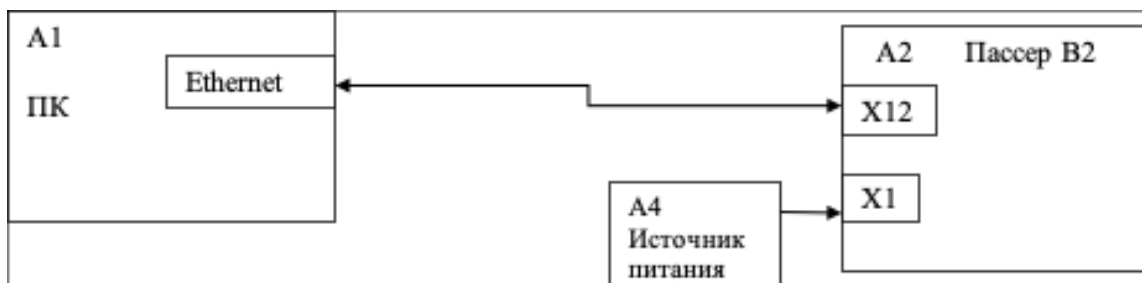
Рисунок 16 – Схема подключения изделия для программирования ПО Системное
